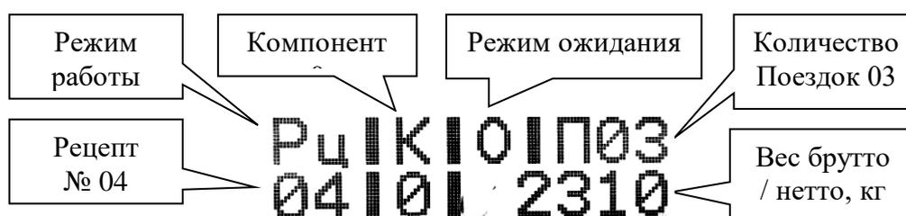
В рабочем режиме экран принимает следующий вид:
